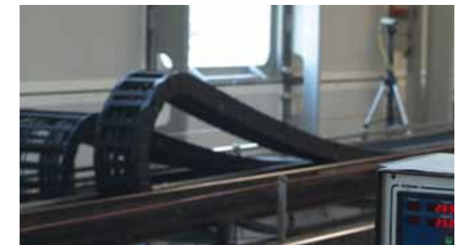
Langer Verfahrenweg – Dauerversuch zur Lebensdauerberechnung
