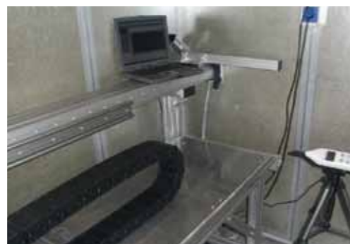
Geräuschermittlung des Laufgeräuschs einer e-kette®
