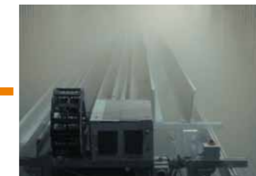
Kältetest von Leitungen und Energieketten bei -40°C
