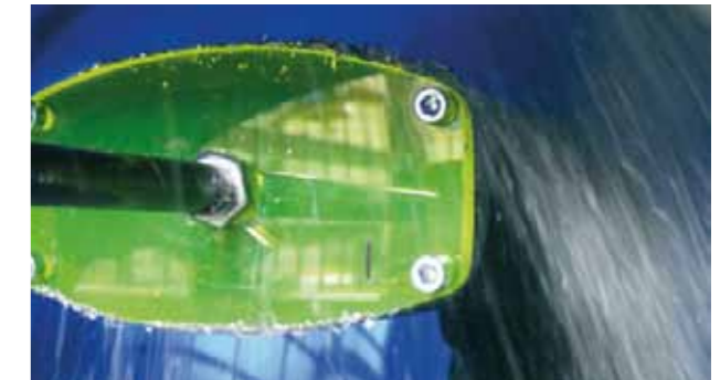
Spänetrommel Prüfung der Spänedichtigkeit von e-rohren
