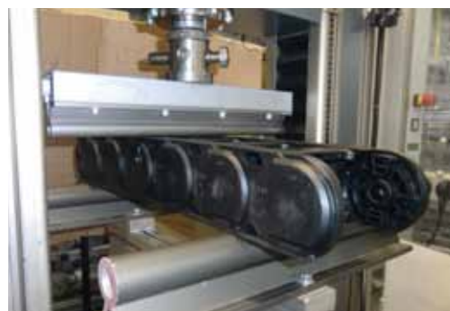
Bruchversuch: Ermittlung der max. freitragenden Länge
