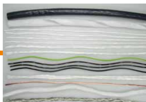
Leitungssezierung zur spezifischen Lebensdauerberechnung
