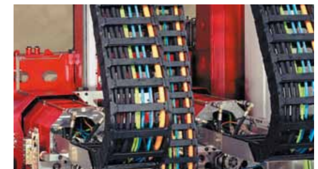
Langer Verfahrenweg – Dauerversuch zur Lebensdauerberechnung
