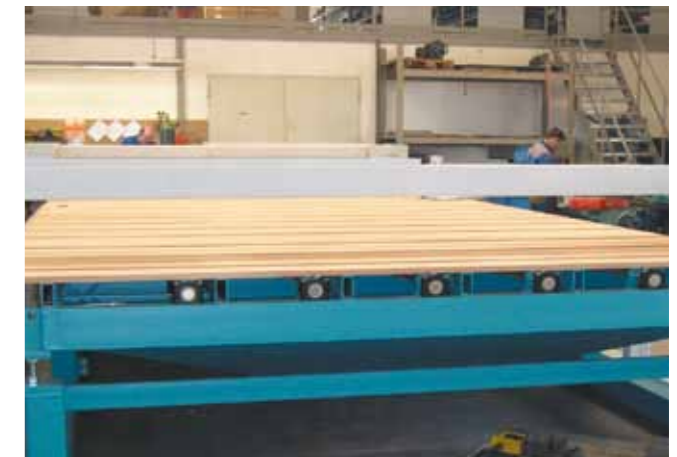
igubal®-Stehlager in einer Plattenhubvorrichtung einer Holzbearbeitungsmaschine igubal® pillow block bearings in a lifting gear for a wood working machine
