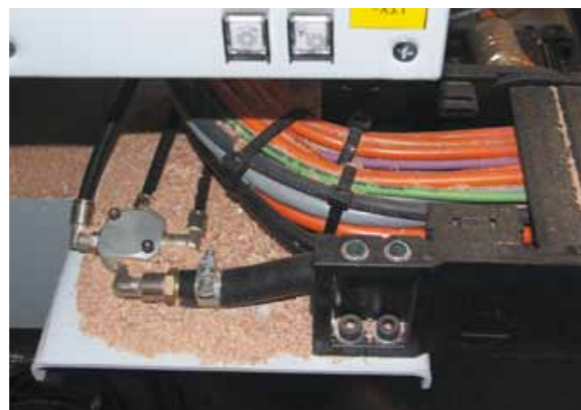
Vorkonfektionierte readychain®-Systeme mit E4 e-rohren für Holzbearbeitungsmaschine Pre-harnessed readychain® systems with E4 e.tubes for sawmill
