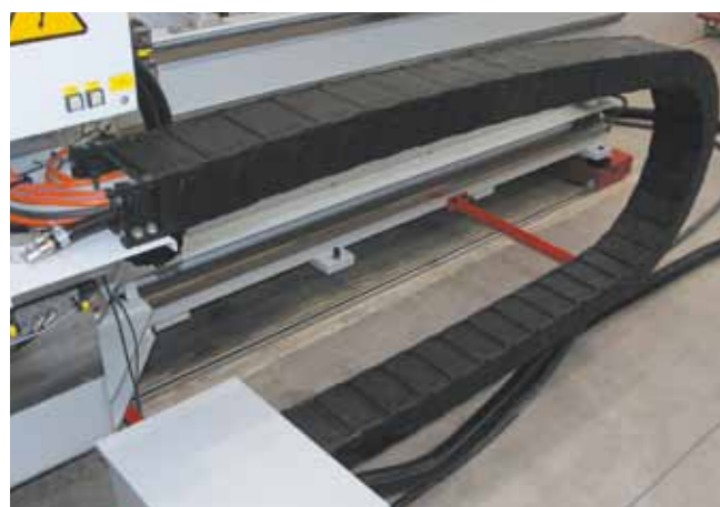
e-rohr der Serie E4 in einem CNC-Holzbohrzentrum e-tube series E4 in a wood bore centre
