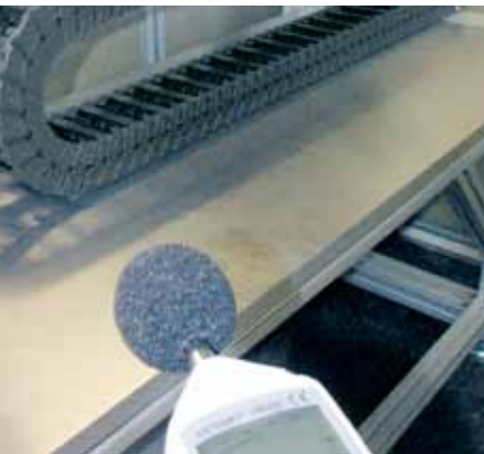
Geräuschprüfung in eigener Schallkammer Noise level test inside an igus® acoustic cell
