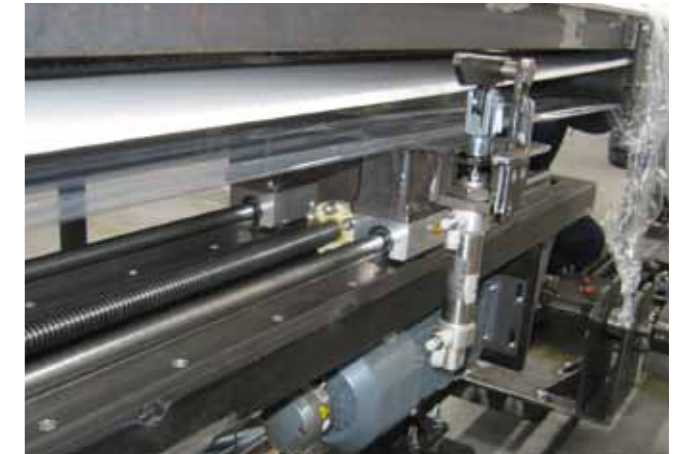
drylin® Trapezgewindemuttern und -spindeln in einer Holzpackanlage drylin® trapezoidal thread nuts and leadscrews in wood-packaging equipment
