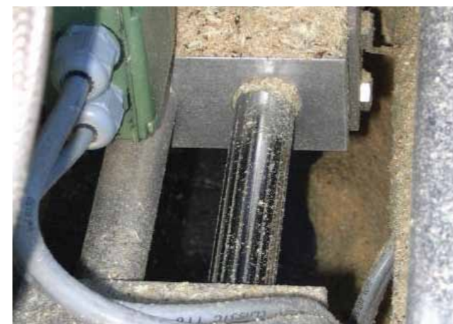
Verschiedene drylin® Produkte in der Sägeblattführung eines mobilen Sägewerks Several drylin® products are used to guide the saw blade in a mobile saw mill
