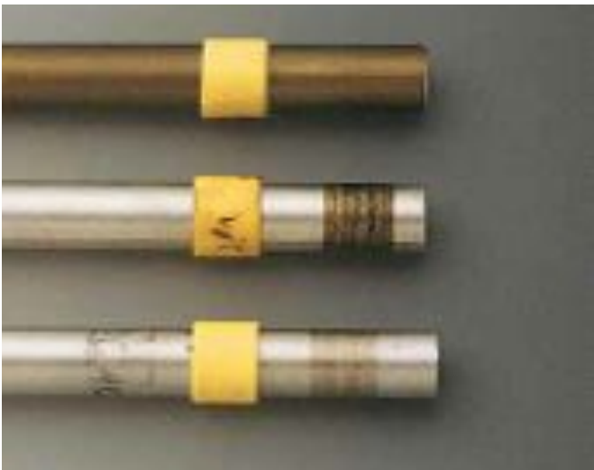
Bild 10: Verschleißuntersuchungen mit Aluminiumwellen
