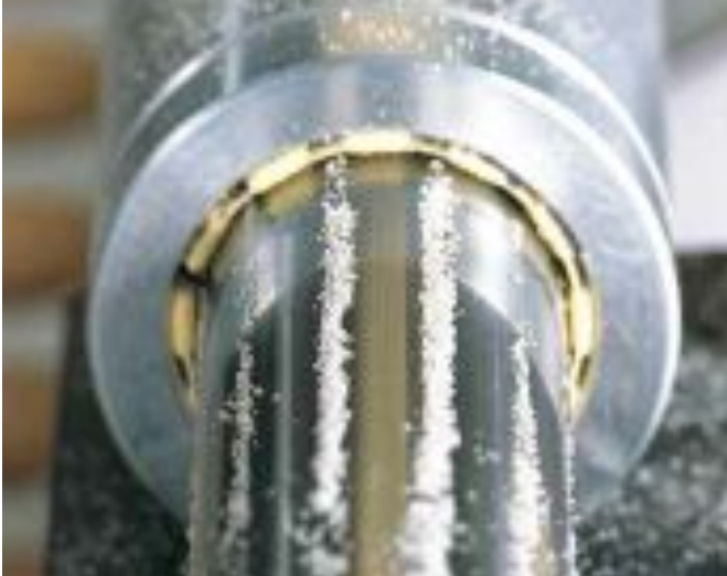
Bild 09: Hohe Verschleißfestigkeit: Gleitlager im permanenten Kontakt mit Sand
