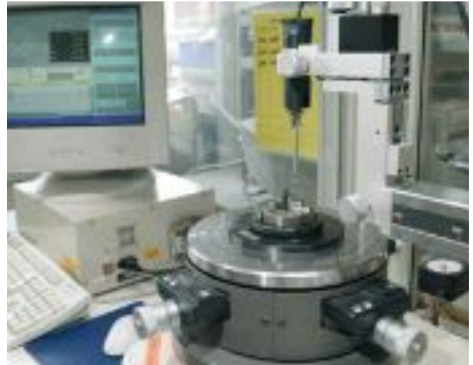
Bild 14: Messung des Innendurchmessers eines eingepressten Gleitlagers
