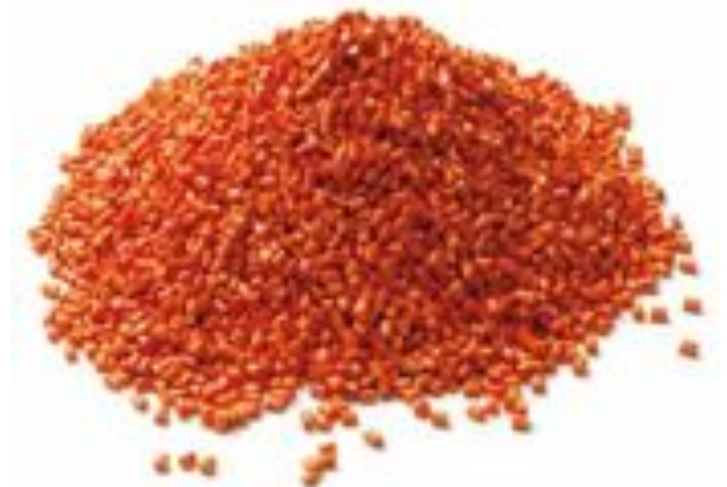
Bild 05: Kunststoffgranulat; Basiskomponente der schmierfreien und berechenbaren iglidur®-Gleitlager
