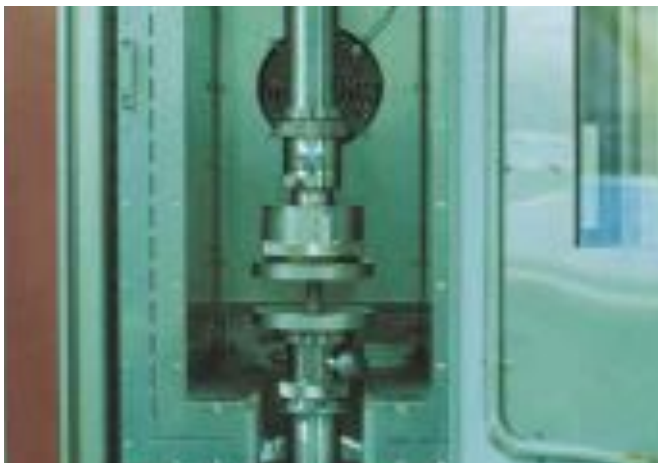
Bild 08: Werkstofftests bis +250°C sind möglich
