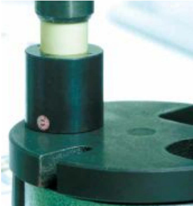
Bild 15: Die Montage erfolgt mit einem ebenen Stempel
