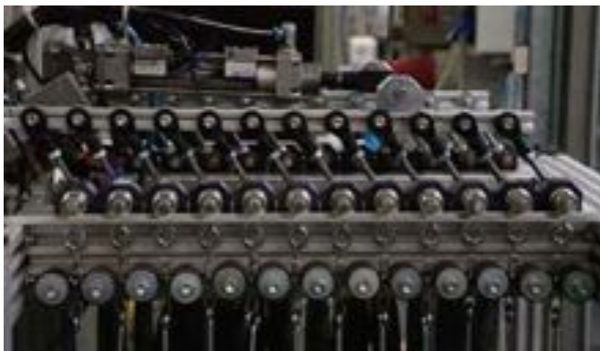
Bild 12: Schwenkverschleiß-Prüfstand zur Prüfung der Verschleißrate schwenkend, für niedrige Belastungen
